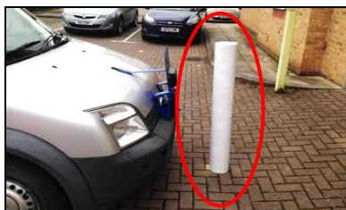
Piquet d'1 m devant une caméra à 0,6 m de haut
